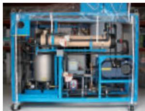
て飲料水に変える緊急用飲料水製造装置です。コンパクトでありながら、3つの濾過装置と消毒装置があり、一日あたり15～25トンの造水処理能力があります。
